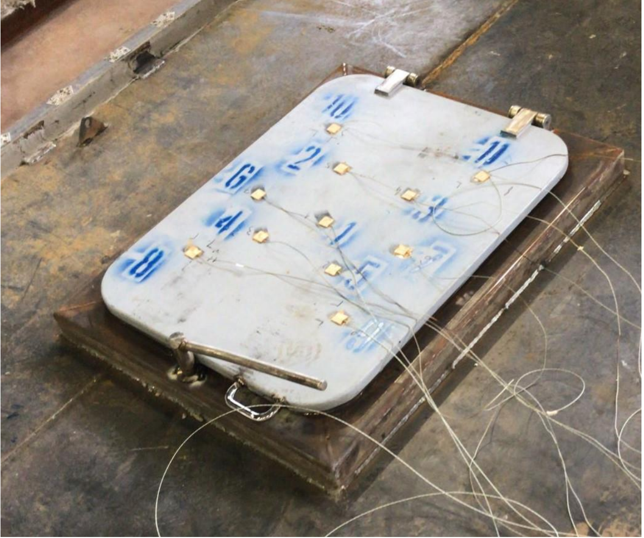
Şekil 1 - Maruz Kalmayan Yüzey Isıl Çift Yerleşimi
